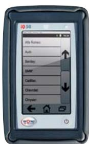
Programovatelný a diagnostický přístroj pro vysoko efektivní průběh práce. Programovatelný a diagnostický přístroj iQ 50 včetně rozhraní systému pro kontrolu tlaku v pneumatikách Snooper+ zvyšuje efektivnost celého průběhu práce od výběru vozidla, evidence, klonování a programování identifikačních čísel ID snímačů až po ukládání datových vět do paměti a jejich individualizaci.
