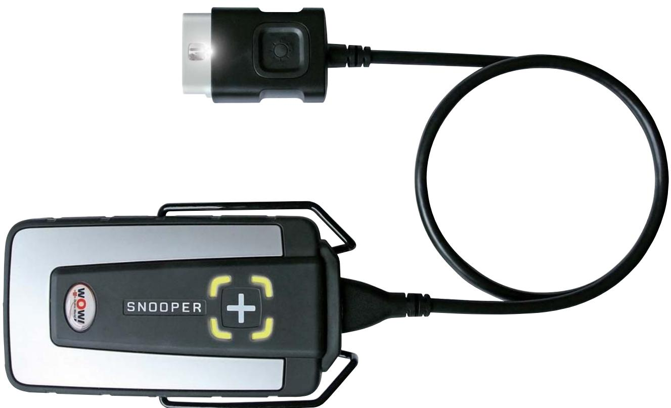
Snooper + je spolehlivý partner pro diagnostiku. S datovým rekordérem pro zápis dat z řídících jednotek během testovací jízdy. Robustní konstrukce s pogumovaným povrchem pro ochranu a snadnou manipulaci, praktický držák. Vestavěná Bluetooth anténa pro spolehlivou bezkabelovou diagnostiku. Diagnostický kabel s vestavěnou LED diodou usnadní hledání diagnostické zásuvky ve voze.
